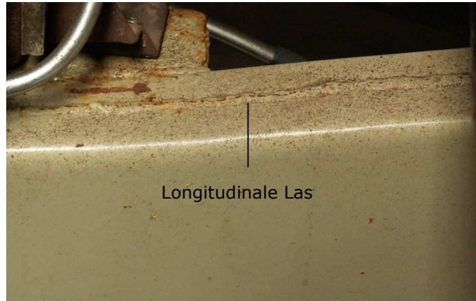
Figuur 7: Longitudinale lasnaad op een chassisbalk, autogeen gelast.
